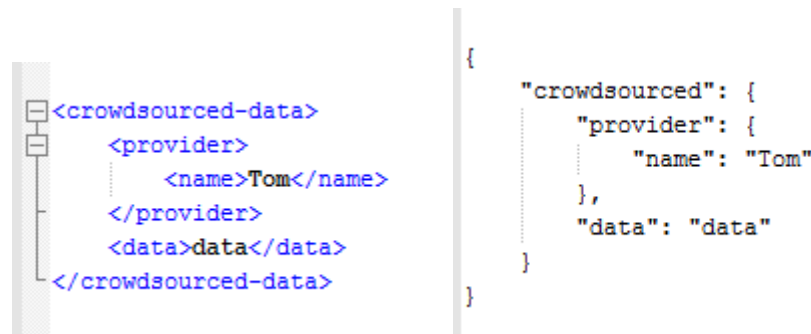
Abbildung 6-3: gleiche Daten in XML- und JSON-Datenformat, XML Datenformat(links), JSON Datenformat(rechts)
