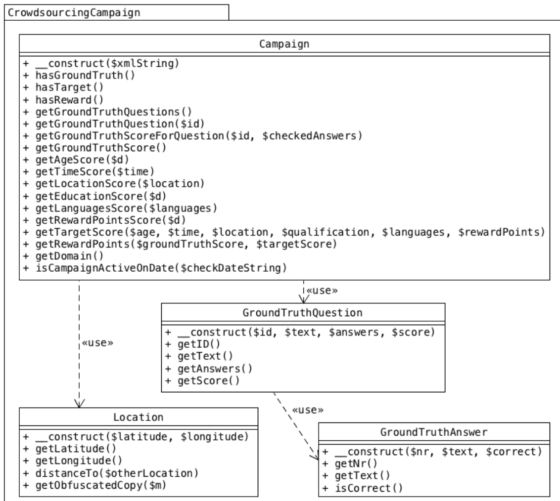
Abbildung 4.1: UML-Klassendiagramm aller für die Kampagnendurchführung implementierten PHP-Klassen
